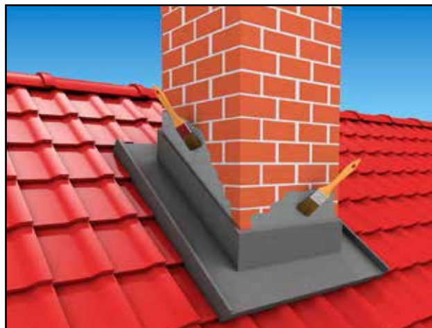
1) Kémények tömítése és lezárása,
